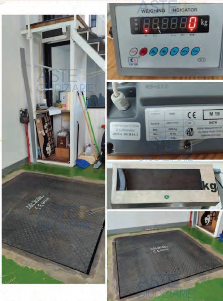
Foto 9 – bilancia per pesatura pedane e due display per lettura peso
