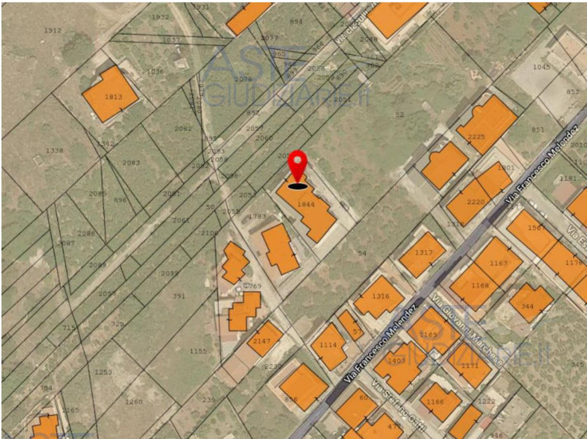
*Sovrapposizione del catastale alla cartografia tecnica comunale. Si evidenzia l'inserimento in mappa della particella sia al C.T. che al C.F.*
