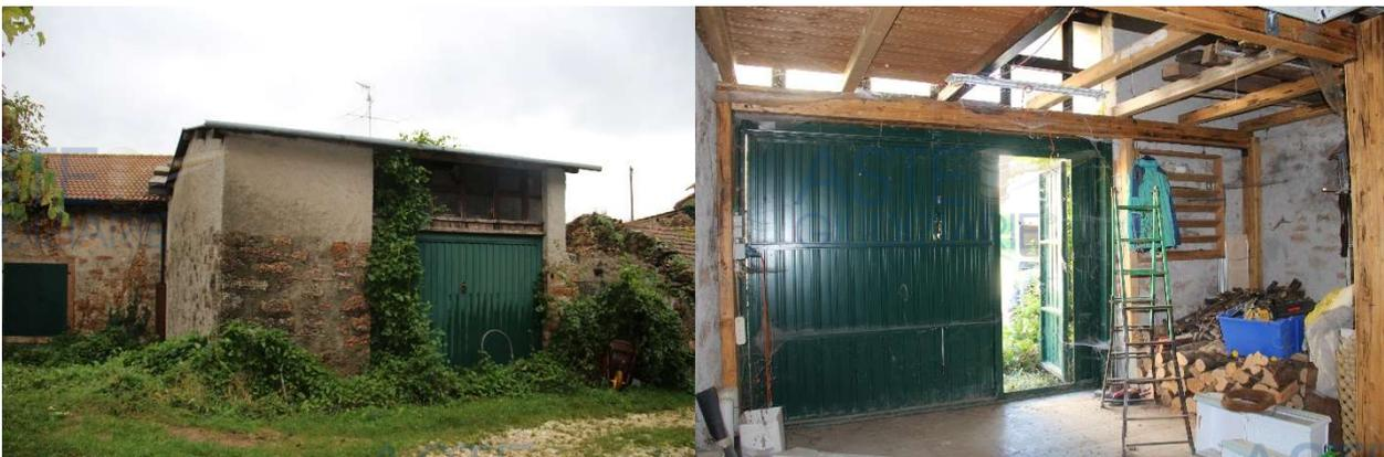
Sviluppa una superficie di circa **37 mq.** e presenta un'altezza variabile tra 2,75 m. e 4,15 m. Ha portone di accesso in metallo basculante, la pavimentazione interna è in piastrelle di ceramica, la muratura non è intonacata. E' presente l'impianto elettrico esterno alla muratura non conforme alle vigenti normative e privo della dichiarazione di conformità.
