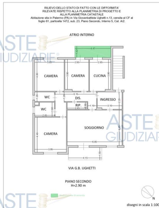
**Planimetria di rilievo dello stato di fatto attuale con evidenza delle difformità rispetto alla planimetria catastale e alla concessione edilizia (ALL. 9)**
