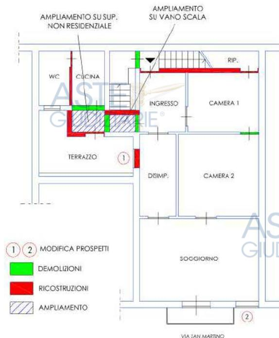
Fig. 30 Rilievo stato reale dei luoghi con indicazione delle difformità (All. 8).
