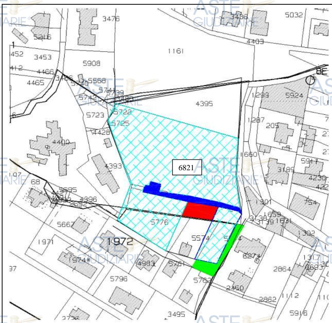
**Fig. 3:** Risultanze del rilievo celerimetrico con indicazione grafica della superficie reale fruibile, di quella occupata dalla stradella di accesso al fondo ed alla cabina Enel (in blu), di quella occupata da viabilità e/o aree di manovra (in verde) e di quella annessa di fatto ad altra particella (in rosso)
