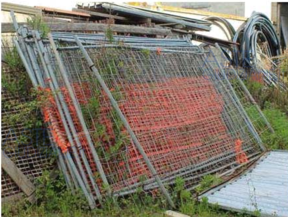
Foto 116 - Elementi di rete per recinzione mobile
