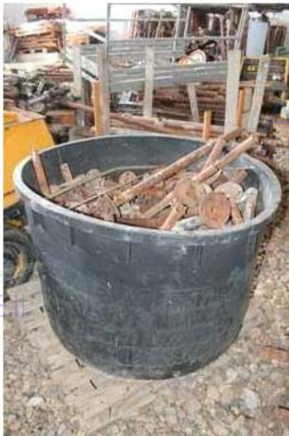
Foto 72 – Mastello pieno di basette per ponteggio.
