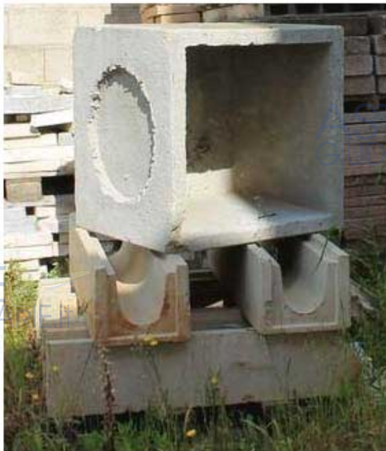
Foto 110 - Quattro elementi di canaletta per fogna in calcestruzzo e pozzetto
