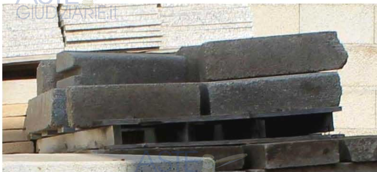
Foto 109 - Blocchi di cordolo stradale maschiato in calcestruzzo
