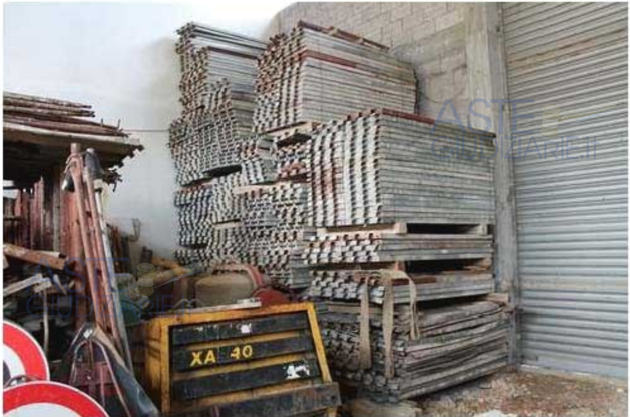
Foto 58 – Altri piani di calpestio, come sopra; circa 500 pezzi, alcuni gravemente deformati, comunque tutti non certificabili come idonei secondo d.lgs. 81-08.
