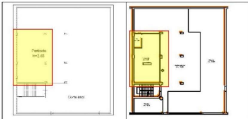
Dal rilievo effettuato si riscontra come al piano terra sia stato realizzato un locale tavernetta, mediante l'ausilio di infissi in legno con vetro camera, e un wc incluso in quest'ultimo, così come evidenziato nel confronto appena riportato.
