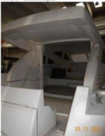
La barca è stata progettata per trasportare 12 persone; consta di una cabina armatore con relativo bagno, due cabine ospiti con relativi bagni, un locale equipaggio con bagno oltre cucina e zona entertainment. L'imbarcazione monta due motori della casa costruttrice CAT tipo C18/CAT 2 x 1014 Cv ciascuno (cfr scheda tecnica che segue).
