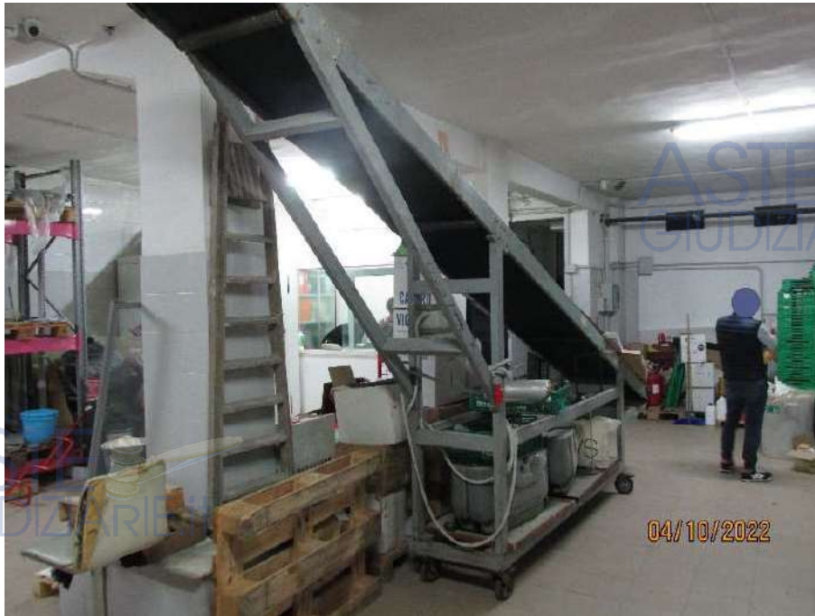
Fotografia 33 – Locale 2/a Sub 102: Nel locale, oltre che a scaffalature varie è presente un nastro trasportatore su ruote, utilizzabile probabilmente per il carico/scarico di merce dall'apertura precedentemente descritta.
