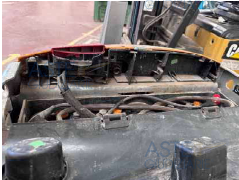
Foto 566: Transpallet STILL EXH-SF20 - vano batteria.
