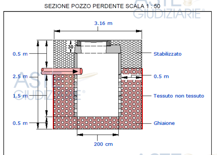
Figura 11: sezione del pozzo perdente
