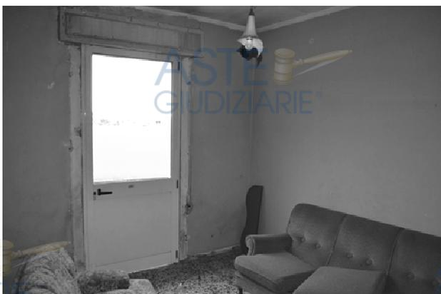
**foto 18** - sub 3 (salotto) - Questo locale, ponendosi tra due camere da letto senza corridoi o disbrighi d'interposizione e affacciando direttamente sul pogggiolo da una porta finestra, non è omologabile come stanza da notte. In caso di pioggia battente, da sotto la porta trafila acqua piovana.
