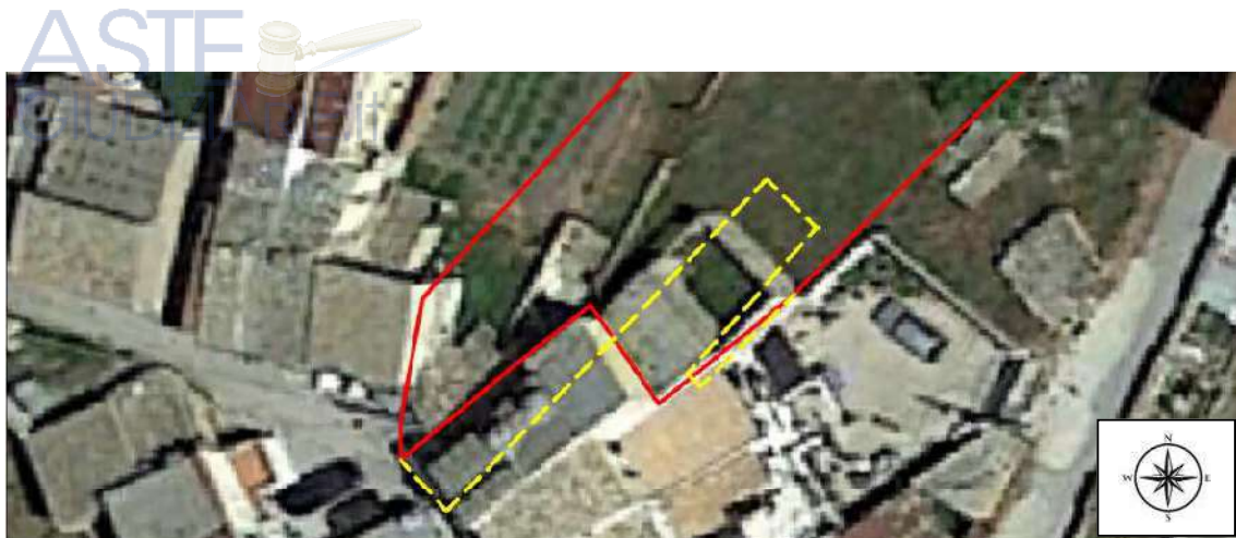
Figure 15 – In rosso il corretto confine della particella 431 in giallo tratteggiato l'errata indicazione catastale
